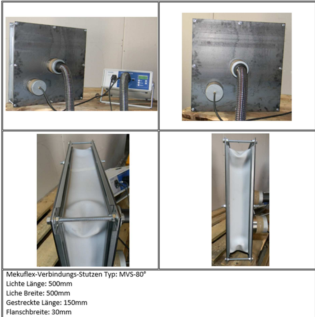
Abbildung 1: Mekuflex-Verbindungs-Stutzen
